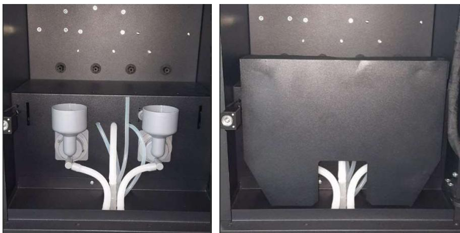
Линии сиропов промываются без разборки. Отключите коннектор от коробки с сиропом и подготовьте емкость с горячей водой. Опустите шланг с
