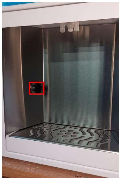
Лоток для слива не закреплен – вытяните его, снимите решетку, слейте отходы и промойте горячей водой.
