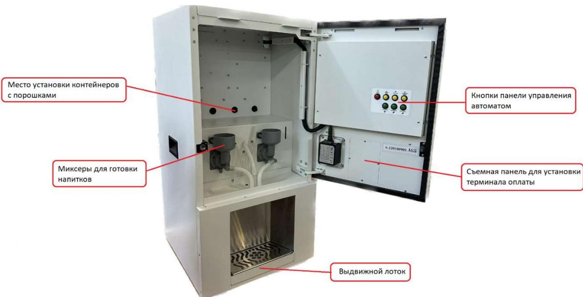
Вид сзади (со снятой крышкой):
