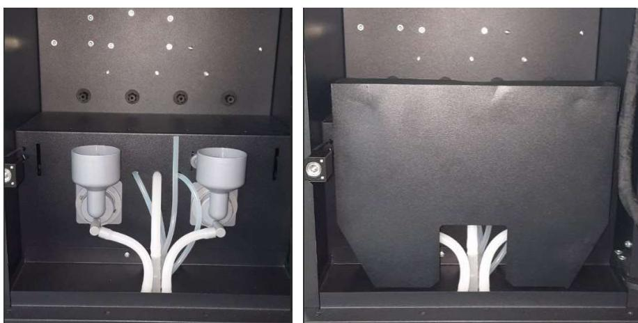
Линии сиропов промываются без разборки. Отключите коннектор от коробки с сиропом и подготовьте емкость с горячей водой. Опустите шланг с коннектором в емкость и нажмите кнопку прокачки сиропа. Промывайте систему до выхода чистой воды в окне выдачи.
