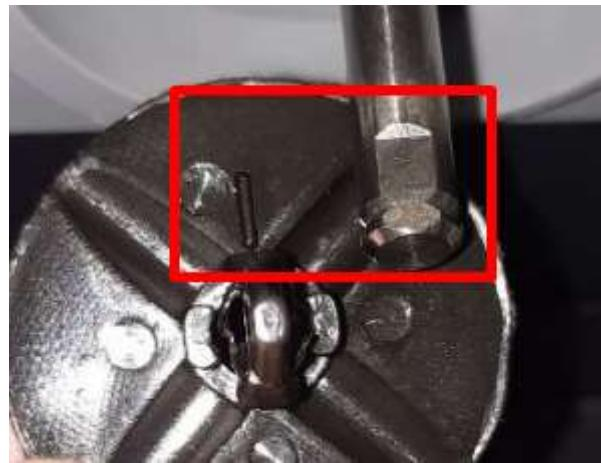
Снимите и промойте горячей воды шланги, идущие от миксеров, а также штуцеры налива. **Изначально шланги прозрачные, но в процессе эксплуатации могут стать изменить цвет из-за оседания мелких частиц.** Для чистки шлангов используйте тонкий ёршик или закажите комплект ЗиП.
