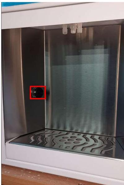
Вытяните лоток для слива, снимите решетку, слейте отходы и промойте горячей водой.
