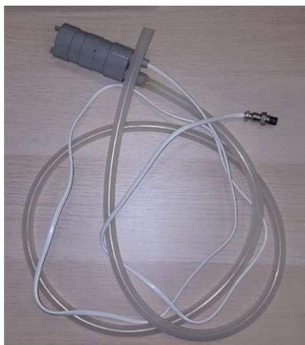
Теплой водой и губкой протрите корпус насоса, шланг и кабель. **ВНИМАНИЕ!** Не допускайте попадания воды на разъем кабеля питания!
