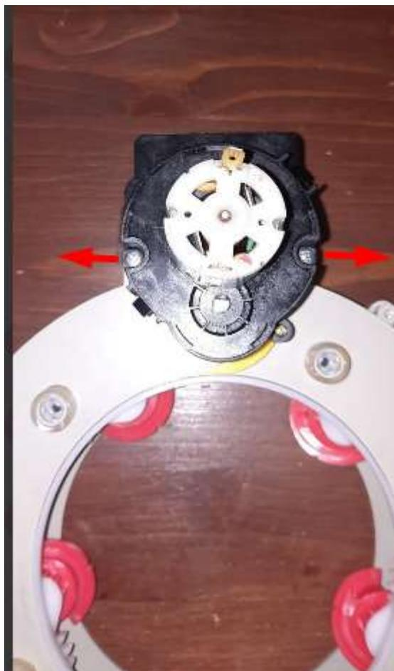
Снимается шестерня и верхняя часть корпуса редуктора:
