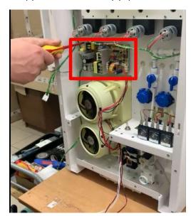
Корпус охладителя вытягивается вперед, затем отключаются шланги на патрубкам вход-выход:
