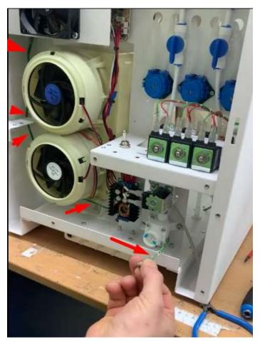
Снизу корпуса открутить 4 крепежных болта
