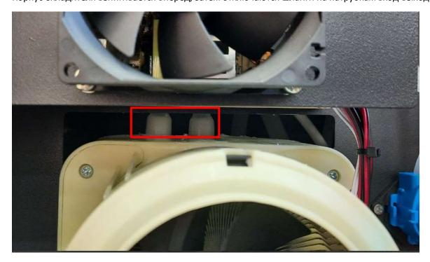
Патрубки можно временно соединить между собой, не потеряв работоспособности автомата на время ремонта / замены охладителя.
